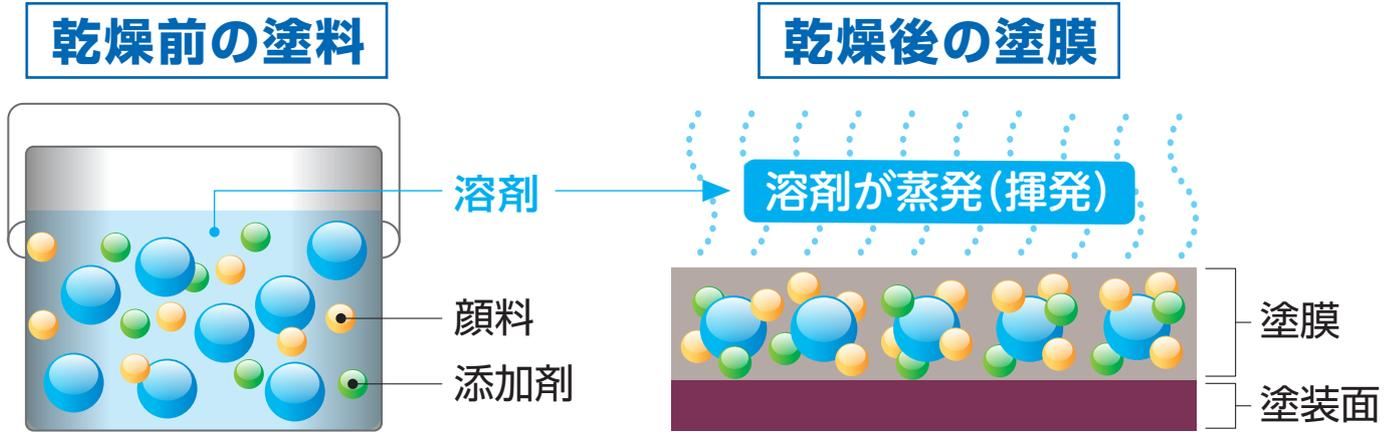
水性と油性の大きな違いは、塗料を液体の状態にして塗れるようにする「溶剤」が水性では水、油性ではうすめ液(シンナー)が溶剤として使われているという事です。溶剤は乾くと蒸発してなくなってしまいますので塗膜が出来た後の水性と油性の大きな違いはありません。また溶剤は塗料の臭いや乾燥時間の違いの要因ともなり、水よりもシンナーの方が臭いが強く、乾燥(蒸発)時間も長くなります。
